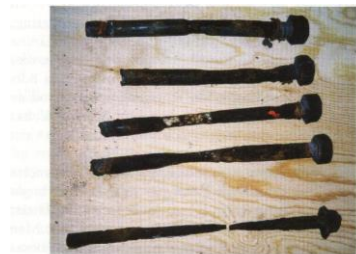
Bild 20:6 Avrostade kølbolter. När den här båten, en Östersjö-å:a, kom till verkstan var hälften av bultarna avrostade, som tur var hade kranbilföraren lagt slingen ner runt kölen vid lyftet.
